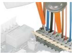
Prüfen mit Prüfspitzen
