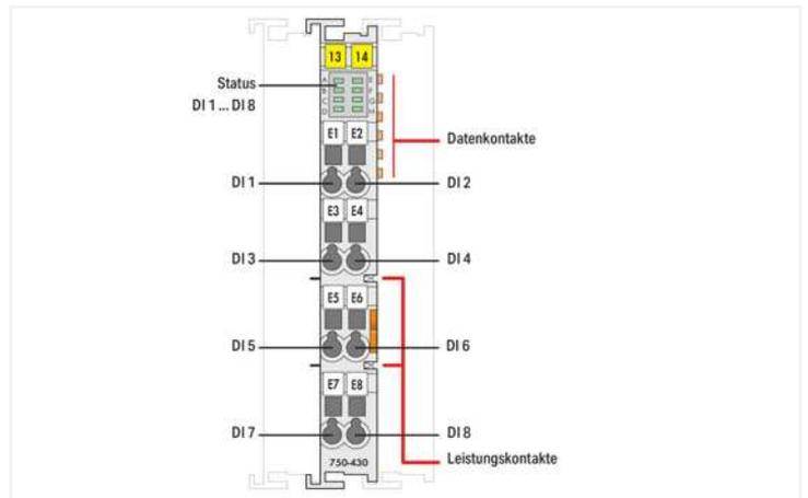
Das Digitaleingangsmodul verfügt bei nur 12 mm Baubreite über 8 Kanäle. Es erfasst Steuersignale aus dem Feldbereich, z.B. über Sensoren. Zur Störunterdrückung ist jedem Eingang ein Filter vorgeschaltet. Feld- und Systemebene sind galvanisch getrennt.
