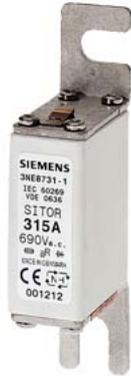
SITOR-Sicherungseinsatz, mit Anschraubflaschen, NH000, In: 125 A, aR, Un AC: 690 V, Un DC: 440 V, Stirnkennmelder
