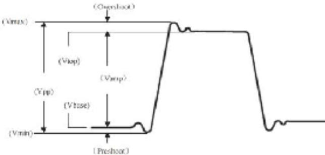
Das Gerät kann folgende Spannungsparameter automatisch messen:
