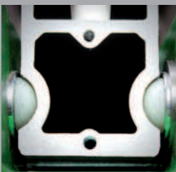
BST 352 V: auf vier Spezialkugeln gelagerter Schlitten
