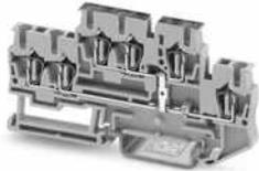
Doppelstockklemme, mit Potenzialverbinder, Nennspannung: 500 V, Nennstrom: 22 A, Anschlussart: Zugfederanschluss, 1. und 2. Etage, Bemessungsquerschnitt: 2,5 mm<sup>2</sup>, Querschnitt: 0,08 mm<sup>2</sup> - 4 mm<sup>2</sup>, Montageart: NS 35/7,5, NS 35/15, Farbe: grau
