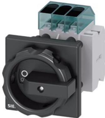
Lasttrennschalter 3LD3, Iu 63 A Hauptschalter 3-polig Bemessungsleistungsleistung bei AC-23 A bei 400V 22,0 kW Frontbefestigung Basisschalter mit Zentrallochbefestigung 22,5mm Knebelantrieb schwarz 66x66 mm mit Hilfsschalter 1OE+1S
