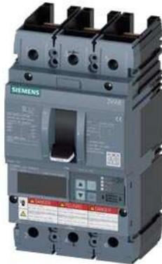
Leistungsschalter 3VA6 UL Frame 150 Schaltvermögenklasse L 150kA @ 480V 3-polig, Anlagenschutz ETU856, LSI, In=40A Überlastschutz Ir=16A...40A Kurzschlusschutz I<sub>sd</sub>=0,6..10x I<sub>n</sub>, I<sub>i</sub>=1,5..12x I<sub>n</sub> N-Leiterschutz optional mit externem Stromwandler, bis 160% Erdschlussalarm Meldung über EFB300 o. COM ohne Anschluss
