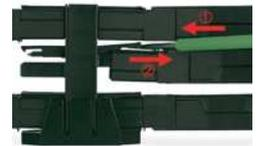
Alle Verbindungen am Verteiler sind direkt nach dem Stecken gegen unbeabsichtigtes Lösen verriegelt. Lösen der Verriegelung mittels Schraubendreher an allen Steckplätzen, auch bei voll belegtem Verteiler.
