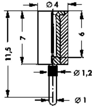
für 1 mm, geschlitzt, Kunststoff isoliert Material: Messing 2  $\mu\text{m}$  Ni, 0,25  $\mu\text{m}$  Au
