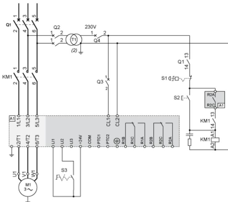
230-VAC-Steuerung, Logikeingänge (LI) 24 VDC, 3-Draht-Steuerung
