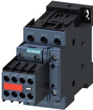
Leistungsschütz, AC-3 32 A, 15 kW / 400 V 2 S + 2 Ö, DC 24 V, mit eingestecktem Varistor 3-polig, Baugröße S0 Schraubanschluss
