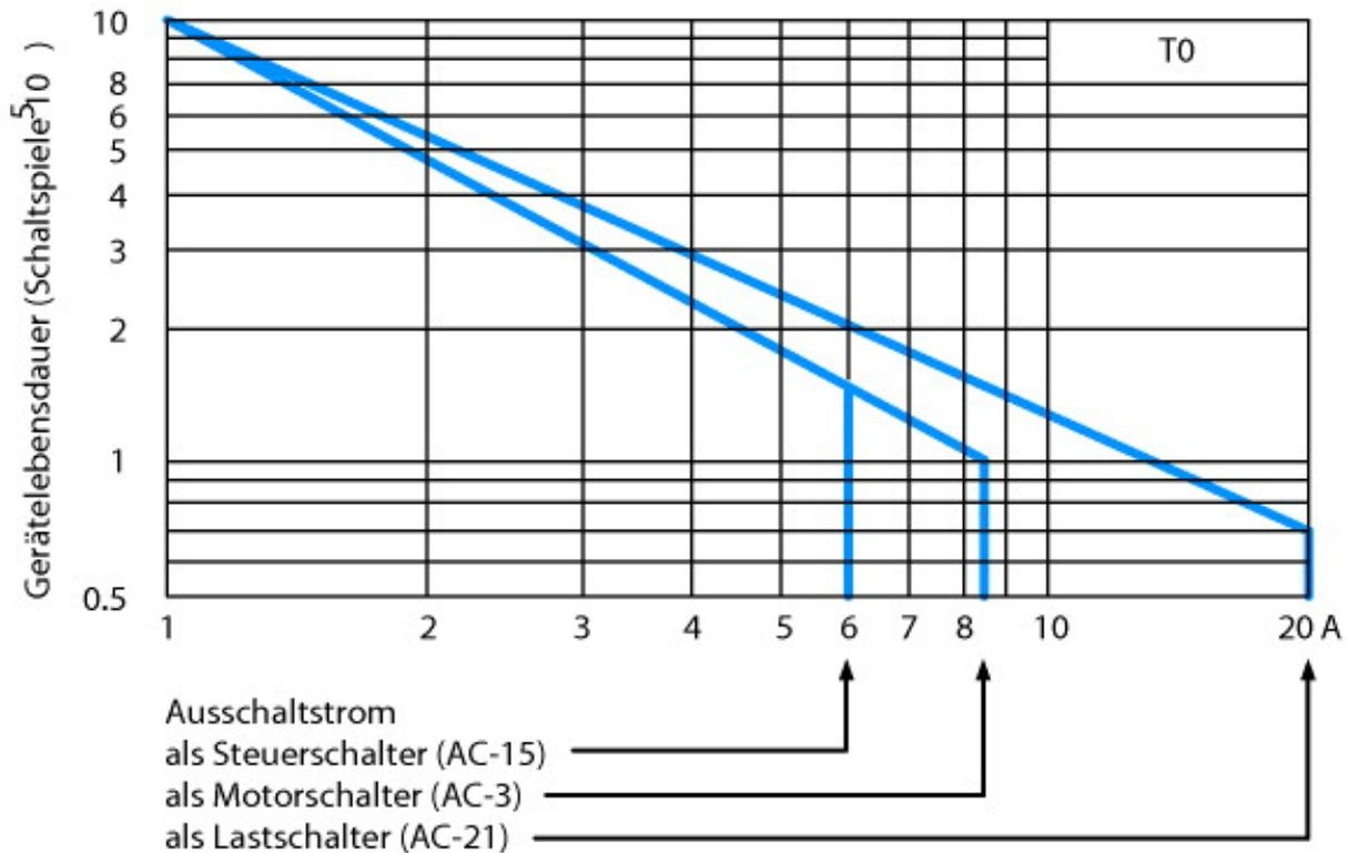
Für Gebrauchskategorie AC-4 (Extremlast: 100 % Tippen, Reversieren oder Gegenstrombremsen) soll zwecks angemessener Lebensdauer der Stillstandstrom des Motors den Bemessungsstrom des Schalters für AC-21A nicht übersteigen.
