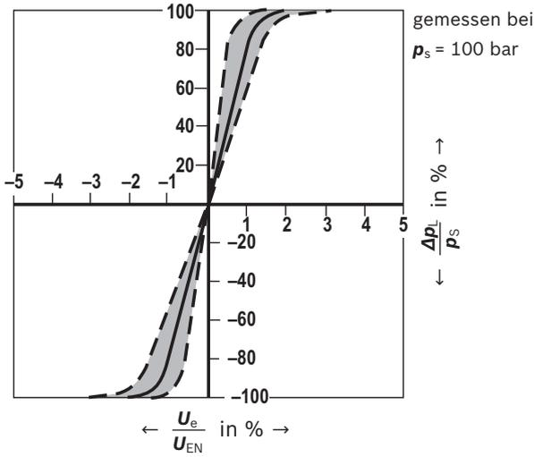
**Nullvolumenstrom der Hauptstufe (Steuerschieber V) ohne Vorsteuerventil**
