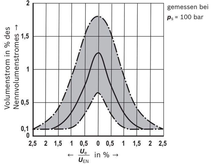
**Volumenstrom-Sollwertfunktion bei z. B. P → A / B → T 10 bar Ventildruckdifferenz oder P → A oder A → T 5 bar pro Steuerkante**
