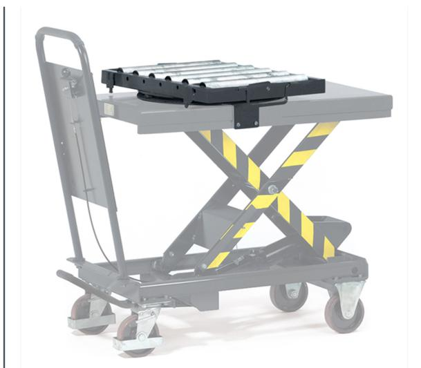
Armature à boulonner sur la plateforme, rotation de 360° avec arrêt. 6 rouleaux à roulement à billes Ø 57 mm et 430 mm de long. Distance entre les axes : 110 mm, Hauteur : 92 mm. Uniquement compatible pour dimensions utiles 1010 x 520 mm.
