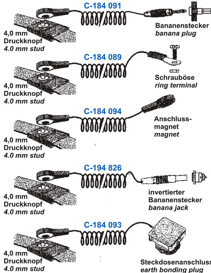
**Standardanschluss für Erdungs-armbänder ist der 4,0 mm Druckknopf, der international kompatibel ist. Für den Masseanschluss stehen verschiedene Kontaktierungsmöglichkeiten zur Auswahl (auf Wunsch sind auch andere Kontaktierungen möglich).**
