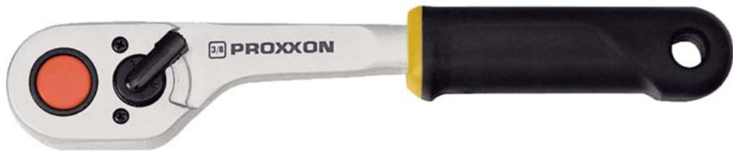
Mit makelloser Verzahnung: Mehrere der 72 Zähne rasten gleichzeitig ein und übertragen ein extremes Drehmoment. Umschalthebel für Rechts- und Linkslauf. Entriegelungs-Mechanismus: Lösen der Einsätze durch Knopfdruck. Kopf und Schaft aus einem Stück CrV-Stahl geschmiedet. 2x vernickelt und matt-verchromt. Griff aus öl- und säurefestem TPR (Thermoplastic Rubber) mit praktischer Bohrung zum Aufhängen.
