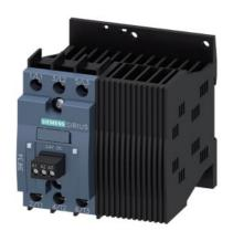
Halbleiterschütz 3-phasig 3RF3 AC 53 / 7,4 A / 40  $^{\circ}\text{C}$  48-480 V / 110-230 V AC Wendeschaltung momentanschaltend Schraubanschluss
