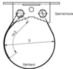
Stahlband um ungeschlitzte Schraube legen. Die Länge des kurzen Bandendes muß ca. ein Drittel des Rohrumfangs entsprechen. Langes Stahlbandende auf Montagelänge schneiden und vorne zuspitzen. Die Montagelänge richtet sich nach dem Mastumfang.
