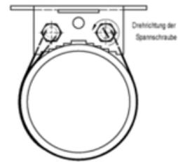
Zugespitztes Stahlbandende in Schlitzschraube stecken und Schraubenkopf nach links drehen. Hierbei wickelt sich das Stahlband um die Spannschraube, und die Bandschelle wird gespannt. Um ein Lockern zu verhindern, wird die Mutter fest angezogen.
