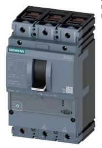
LEISTUNGSSCHALTER 3VA2 IEC FRAME 160 SCHALTVERMOEGENKLASSE H ICU=85KA @ 415 V 3-POLIG, ANLAGENSCHUTZ ETU340, ELISA LI, IN=40A UEBERLASTSCHUTZ IR=16A ...40A KURZSCHLUSSSCHUTZ II=15 X IN KLEMMENANSCHLUSS
