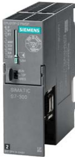
SIMATIC S7-300 CPU317F-2 PN/DP, ZENTRALBAUGRUPPE MIT 1,5 MBYTE ARBEITSSPEICHER, 1.SCHNITTST. MPI/DP 12MBIT/S, 2.SCHNITTST. ETHERNET PROFINET, MIT 2 PORT SWITCH, MICRO MEMORY CARD ERFORDERLICH
