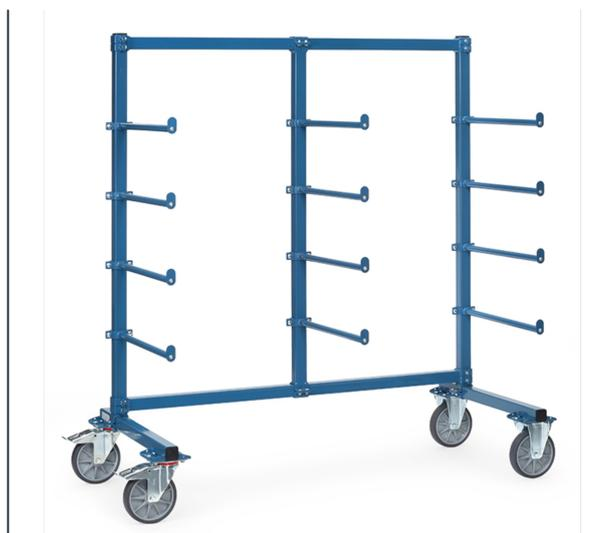
Ensemble mécano-soudé, revêtement époxy bleu RAL 5007. Système modulable pour éléments longs et stockage. Chariot complètement boulonné, barres réglables en hauteur. 1 face avec 12 barres de portée habillées d'un tube de PVC de 3 mm d'épaisseur et avec butée de sécurité. Longueur utile : 600 mm. 2 roues fixes et 2 roues pivotantes à bandage TPE, moyeu à roulement à billes. Freins sur roues pivotantes conformément à la Norme EN 1757-3. Charge par étage : 80 kg.
