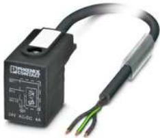
Sensor-/Aktor-Kabel, 3-polig, PVC, schwarz RAL 9005, freies Leitungsende, auf Ventilstecker BI (11 mm), mit 1 LED, beschaltet mit Varistor, Kabellänge: 5 m
