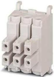
Kontakteinsatz, Artikelfamilie: VARIOCON, Kontakteinsatz, Material Gehäuse: Polyamid, Farbe: lichtgrau, Polzahl: 6, Aderquerschnitt min.: 0,14 mm<sup>2</sup>, Aderquerschnitt max.: 1,5 mm<sup>2</sup>, Bemessungsspannung: 250, Bemessungsstrom: 10 A, Anschlussart: Schraubanschluss, Kontaktart: Buchse. Steckverbinder dürfen nur leistungslos betätigt werden.
