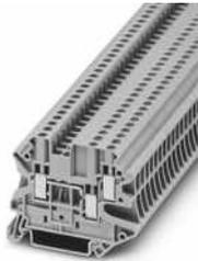
Durchgangsklemme, Nennspannung: 500 V, Nennstrom: 24 A, Anschlussart: Schraubanschluss, 1. Etage, Bemessungsquerschnitt: 2,5 mm<sup>2</sup>, Querschnitt: 0,14 mm<sup>2</sup> - 4 mm<sup>2</sup>, Montageart: NS 35/7,5, NS 35/15, Farbe: grau
