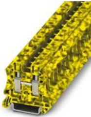
Durchgangsklemme, Nennspannung: 1000 V, Nennstrom: 57 A, Anschlussart: Schraubanschluss, Bemessungsquerschnitt: 10 mm<sup>2</sup>, Querschnitt: 0,5 mm<sup>2</sup> - 16 mm<sup>2</sup>, Montageart: NS 35/7,5, NS 35/15, Farbe: schwarz/gelb
