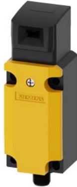
Sicherheits-Positionsschalter mit getrenntem Betätiger, Metallgehäuse 40 mm, mit M12-Stecker, Kunststoff 5-polig, maximal 125 V, 4 A, 5 Anfahrrichtungen. Schleischieltglieder 2 Ö angeschlossen, PIN1=21, PIN4=22, PIN2=31, PIN5=32 PIN3=PE.. Geeignet zum Anschluss an alle SIMATIC ET200\* kompakte Blockperipheriegruppen. Der dazu passende getrennte Betätiger 3SE5000-0AV../W..muss separat bestellt werden.
