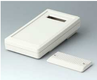
A9073307 DATEC-MOBIL-BOX S, Ausf. III ABS (UL 94 HB) grauweiß RAL 9002 152x83x33,5mm IP 65 opt.
