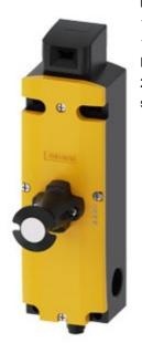
Sicherheits-Positionsschalter mit Zuhaltung Zuhaltekraft 1300 N 5 Anfahrrichtungen Kunststoffgehäuse, M12-Stecker ASIsafe integriert hohe Schutzart IP69, IEC 60529 Kanal 1=Betätiger 2Ö Kanal 1=Betätiger 2Ö nach Prinzip der 2v2-Auswertung Kanal 2=Magnet 1Ö federkraftverriegelt Fluchtentriegelung vorne Magnetspannung DC/AC 24 V Überwachung Betätiger 2Ö/1S Überwachung Manet 2Ö/1S der dazu passende getrennte Betätiger 3SE5000-0AV0 muss separat bestellt werden
