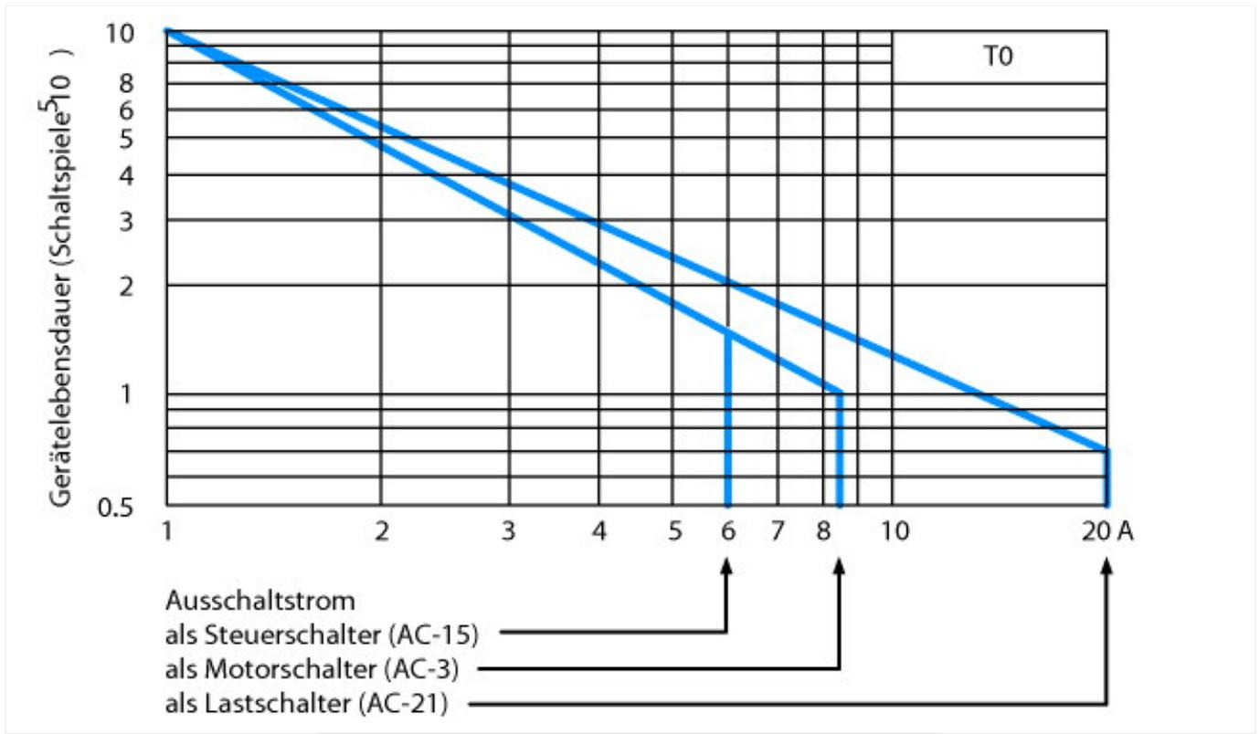
Für Gebrauchskategorie AC-4 (Extremlast: 100 % Tippen, Reversieren oder Gegenstrombremsen) soll zwecks angemessener Lebensdauer der Stillstandstrom des Motors den Bemessungsstrom des Schalters für AC-21A nicht übersteigen.
