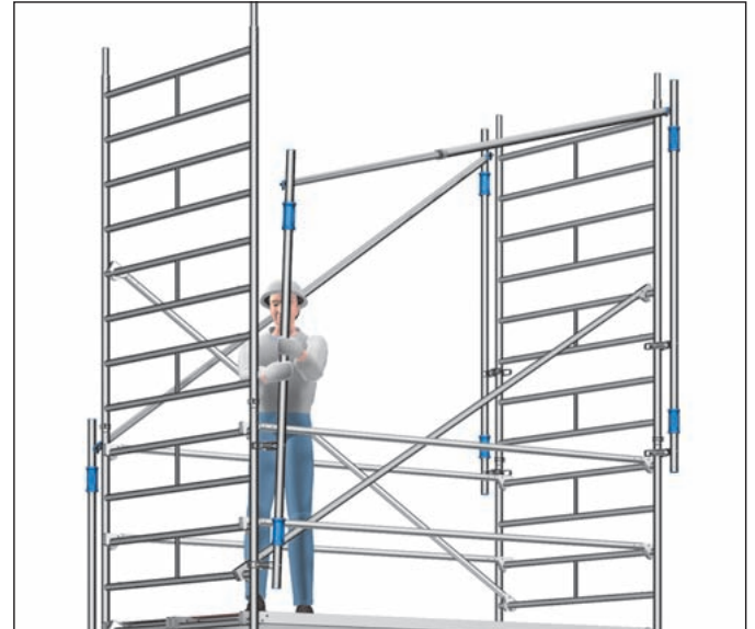
Bild 5: Versetzen des MSG nach oben
