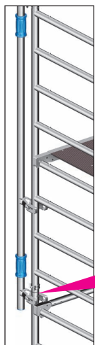
Bild 4: Anschluss Montagepfosten an der Standleiter
