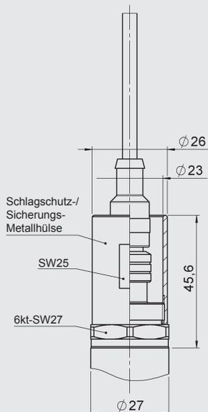
Die Schlagsschutz- / Sicherungs-Metallhülle ist im Lieferumfang enthalten. Für den elektr. Anschluss ist eine gerade Kupplungsdose erforderlich. Z.B. Kupplungsdose M12x1, 4-polig, gerade mit 3m Leitung geschirmt: ZBE 06S-03, Mat.-Nr. 6098243
