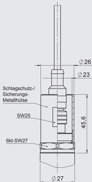
Die Schlagschutz- / Sicherungs-Metallhülse ist im Lieferumfang enthalten. Für den elektr. Anschluss ist eine gerade Kupplungsdose erforderlich. Z.B. Kupplungsdose M12x1, 4-polig, gerade mit 3m Leitung geschirmt: ZBE 06S-03, Mat.-Nr. 6098243
