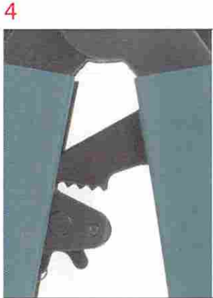
... until the contact is held (1. Ratchet Lever). ...bis der Kontakt gehalten wird (1. Rastung).
