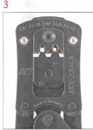
Insert the terminal into the respective profile and close the tool lightly ... Legen Sie den Kontakt in das entsprechende Profil und schließen Sie das Werkzeug vor ...
