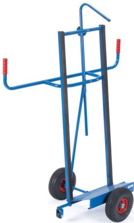
Stahlrohr-Konstruktion mit Stahlblechschaufel, Anlagen mit Profilgummi belegt (rutschsicher), und einstellbarem Niederhalter als Kippsicherung. Pulverbeschichtet blau RAL 5007. Räder mit Vollgummibereifung. Naben mit Rollenlager. 2 Stützrollen 50 mm Ø. Zerlegte Anlieferung. Zum Längstransport von großflächigen Holz- und Kunststoffplatten.
