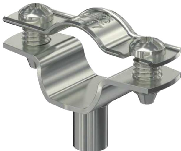
Abstandschelle zur Montage von Rohren und Kabeln an Wand, Decke und Boden. Mit selbstsicherndem Oberteil. Befestigung über Ansatz mit Innengewinde. Oberflächen G und FT ab Schellengröße 20 geeignet für Montage mit Nagelgerät oder Bolzensetzgerät. Zugelassen für den Funktionserhalt nach DIN 4102 Teil 12, Funktionserhaltklassen E 30 bis E 90.
