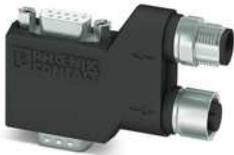
D-SUB-Stecker, 9-polig, Stift, mit PG-D-SUB-Buchse, Belegung: 3, 5, 6, 8; zwei M12-Kabelzuführungen (B-kodiert) unter 90°. Bussystem: PROFIBUS DP bis 12 MBit/s. Abschlusswiderstand über separaten M12-Terminator.
