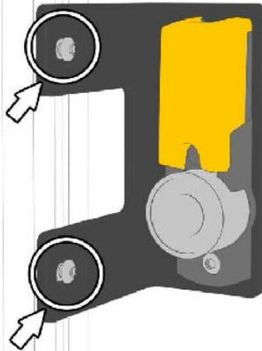
Abb.8: Montageplatte mit Prozesszuhaltung am Profil anbringen und Schrauben M8 x 12 mm Torx festziehen.
