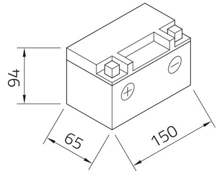
Technologie Verschlussene AGM (Elektrolyt in Glasfaser-Vlies gebunden) | gefüllt und geladen | absolut wartungsfrei
