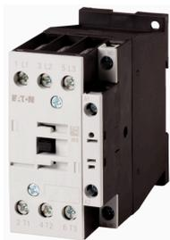
**Leistungsschütz, 3-polig, 380 V 400 V 11 kW, 1 S, 230 V 50 Hz, 240 V 60 Hz, Wechselstrombetätigung, Schraubklemmen**
