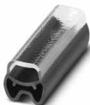
Ader-Bezeichnungsträger, transparent/schwarz, unbeschriftet, Montageart: aufschieben, Kabeldurchmesserbereich: 1,3 ... 2,8 mm, Schriftfeldgröße: 15 x 4 mm
