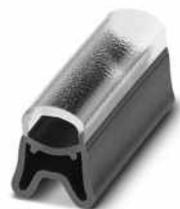
Ader-Bezeichnungsträger, transparent/schwarz, unbeschriftet, Montageart: aufschieben, Kabeldurchmesserbereich: 2 ... 4 mm, Schriftfeldgröße: 15 x 4 mm
