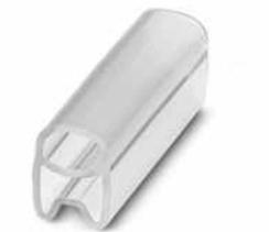
Ader-Bezeichnungsträger, transparent, unbeschriftet, Montageart: aufschieben, Kabeldurchmesserbereich: 1,5 ... 2,5 mm, Schriftfeldgröße: 15 x 4 mm
