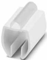
Ader-Bezeichnungsträger, transparent, unbeschriftet, Montageart: aufclipsen, Kabeldurchmesserbereich: 6,7 ... 10 mm, Schriftfeldgröße: 4 x 15 mm
