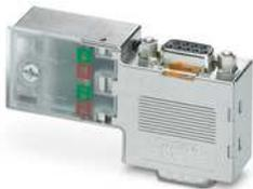
D-SUB-Stecker, 9-polig, Stift, Kabelzuführung unter 90°, Bussystem: PROFIBUS DP bis 12 MBit/s mit PG-D-SUB-Buchse zum Anschluss eines Programmiergeräts, Abschlusswiderstand ü. Schiebeschalter zuschaltbar, Pinbelegung: 3, 5, 6, 8; Schraubanschlussklemmen
