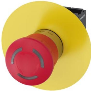
NOT-HALT-Pilzdrucktaster, beleuchtbar, 22 mm, rund, Metall, hochglanz, rot, 40 mm, zwangsläufige Verrastung, gemäß DIN EN ISO 13850, Drehentriegelung, mit gelbem Unterlegschild, ohne Beschriftung, mit Halter, 1Ö, 1Ö, LED 24V rot, Federzuganschluss, Frontplattenbefestigung
