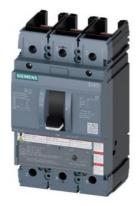
Leistungsschalter 3VA5 UL Frame 250 Schaltvermögenklasse M 35kA @ 480V 3-polig, Anlagenschutz TM210, FTFM, In=70A Überlastschutz Ir=70A fest eingestellt Kurzschlussschutz li=10 x In ohne Anschluss
