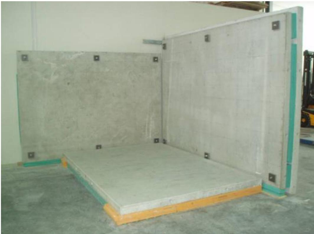
Abbildung 2: Empfangsplattenprüfstand der Hochschule für Technik Stuttgart
