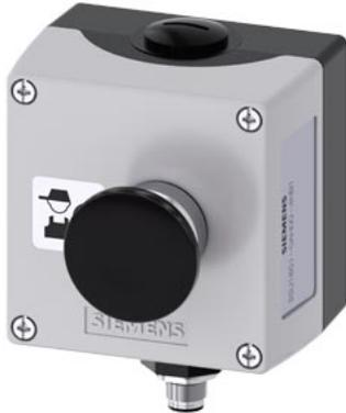
Gehäuse für Befehlsgeräte, 22 mm, rund, Gehäusematerial Metall, Gehäuseoberseite grau, 1 Befehlsstelle Metall, A=Pilzdrucktaster, schwarz, 40mm, tastend, 1S, Federzuganschluss, Bodenbefestigung, Schild silber, Schrift schwarz, mit grafischem Symbol: AUTOPLAY, M12-Stecker (5-polig) unten, isolierte Reserveadern Schild eingeklebt
