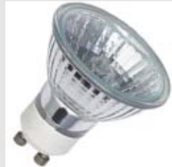
Halogenglühlampe 50x53mm Hochvolt Halogenglühlampe mit ALU-Reflektor, GU10, Abstrahlwinkel 35°, mit Frontglas, zum Einsatz in neuen Hochvolt-Systemen und Einbaustrahlern.
