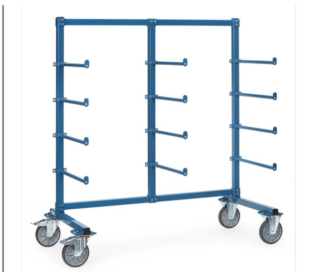
Ensemble mécano-soudé, revêtement époxy bleu RAL 5007. Système modulable pour éléments longs et stockage. Chariot complètement boulonné, barres réglables en hauteur. 1 face avec 12 barres de portée avec butée de sécurité. Longueur utile : 600 mm. 2 roues fixes et 2 roues pivotantes à bandage TPE, moyeu à roulement à billes. Freins sur roues pivotantes conformément à la Norme EN 1757-3. Charge par étage : 80 kg.
