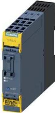
SIRIUS Sicherheitsschaltgerät Grundgerät 3SK2 Reihe 10 F-DI, 2 F-DQ, 1 DQ, 24 V DC parametrierbar über SIRIUS Safety ES 22,5 mm Baubreite Federzuganschluss (Push-In) bis SIL 3 (IEC 62061) bis Performance Level e (ISO 13849-1) Ausgangserweiterungen 3SK1, Koppelrelais 3RQ1 und fehlersichere Motorstarter 3RM1 über Geräteverbinder anschließbar
