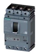
Leistungsschalter 3VA2 IEC Frame 100 Schaltvermögenklasse M Icu=55kA @ 415V 3-polig, Anlagenschutz ETU330, LIG, In=63A Überlastschutz Ir=25A...63A Kurzschlussschutz Ii=1,5...12 x In Erdschlussschutz Ig=0,25... 1 x In, tg=0,1/0,3s Schraubenflachanschluss
