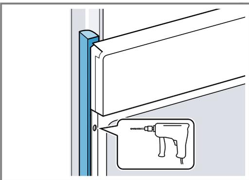
3. Gerät mit adäquater Schraube befestigen.
